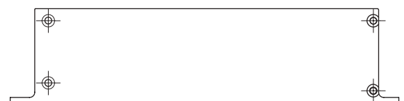
Endplatte NP I1; Maßstab 1:2 end plate NP I1; scale 1:2
