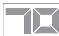
FL/B-CUT Gehungsschnitt für L-, U- oder Q-Konfiguration Bevel cut for L-, U- or Q-configuration
